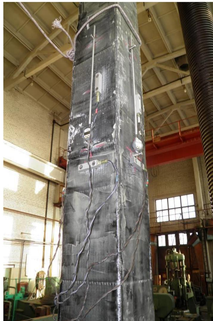
Вид усиленных холстами образцов подвергшихся испытаниям на прочность
