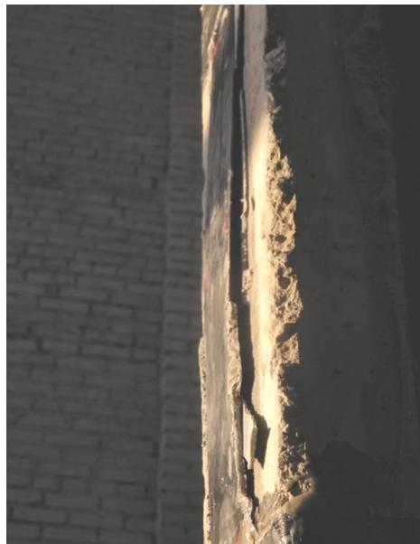
← Вид усиленных лентой образцов (без хомутов) подвергшихся испытаниям на прочность
