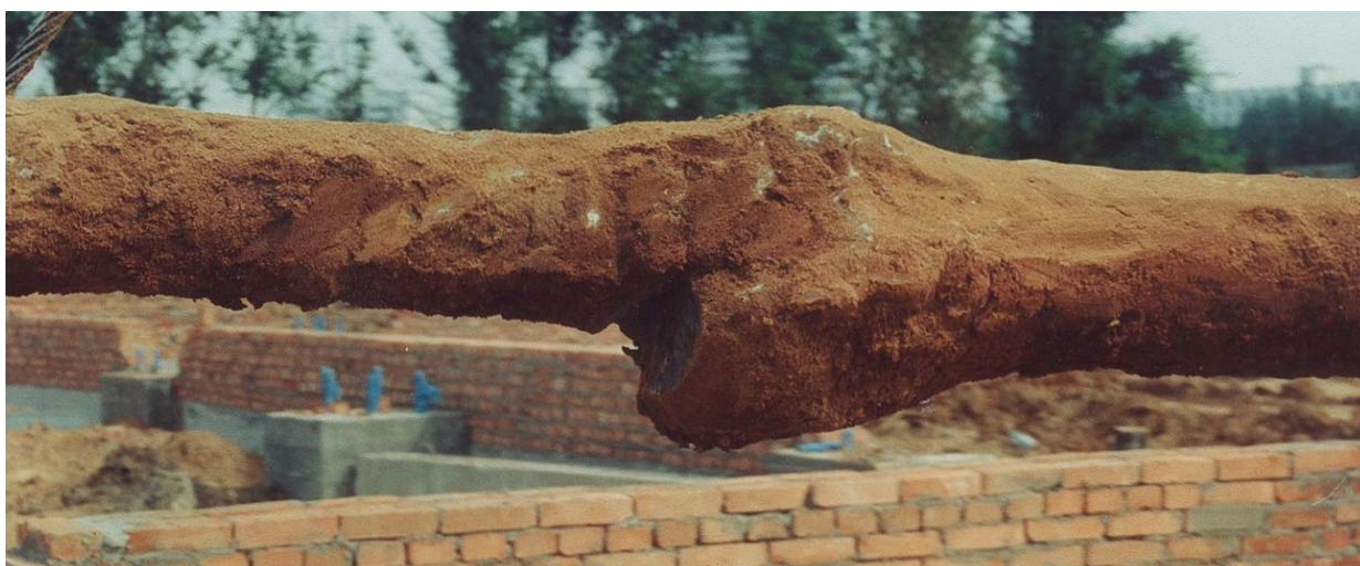
Супесь в зоне формирования камуфлетного уширения анкера.
