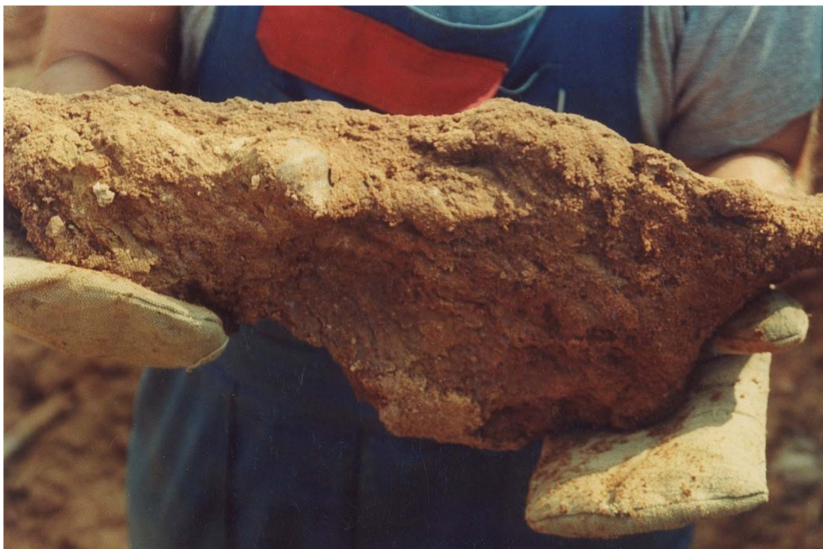
Супесь в зоне формирования камуфлетного уширения анкера.
