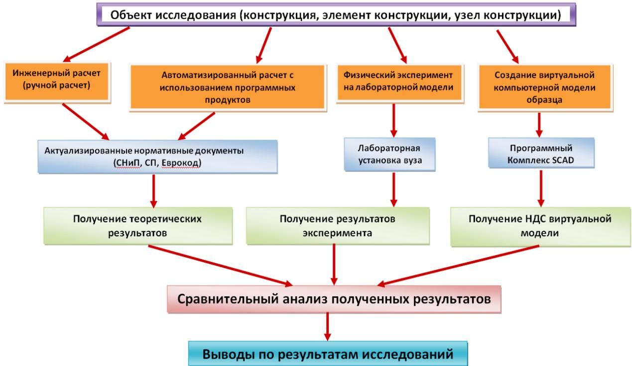
Рисунок 1. Принципиальная схема комплексной лабораторной работы
