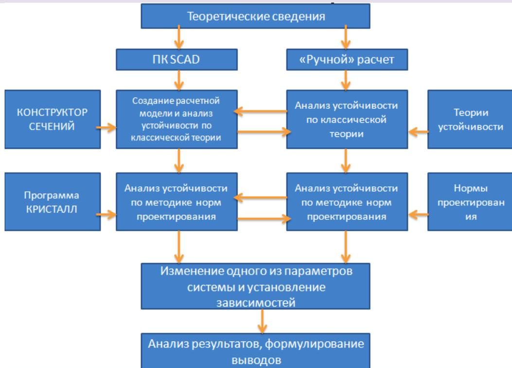
Рисунок 2. Схема выполнения виртуальной лабораторной работы «Анализ устойчивости центрально-сжатой стойки сквозного сечения»
