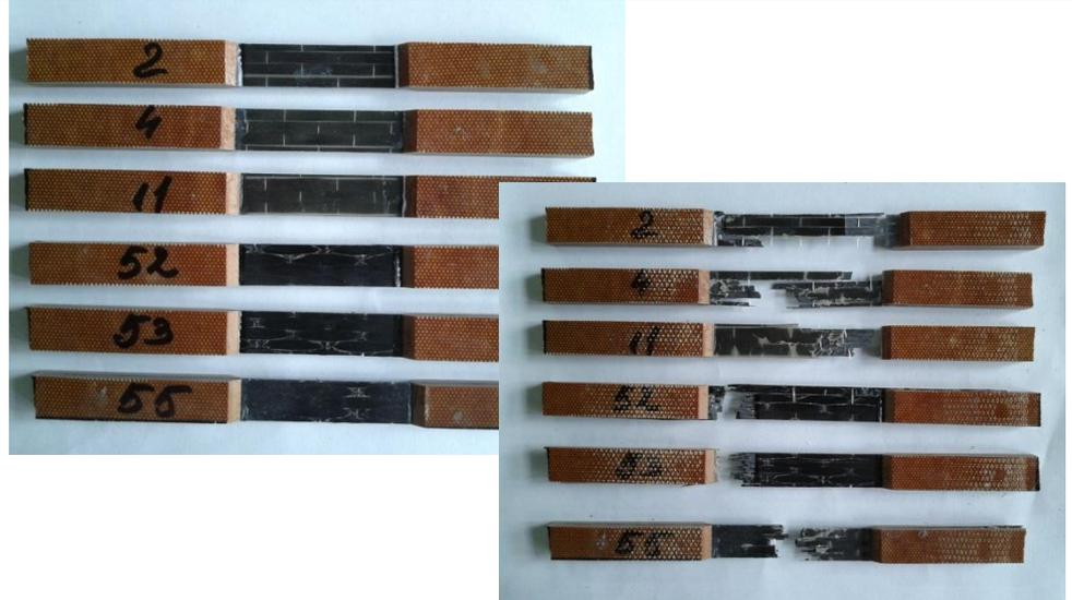
Внешний вид облучённых образцов до и после испытания на растяжение
