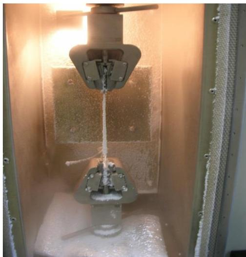
Испытание образцов СВА на растяжение при отрицательной температуре
