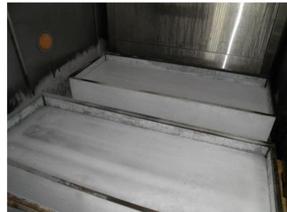
Усиленные образцы: попеременное замораживание и оттаивание
