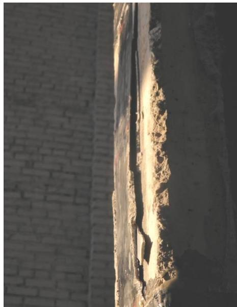
← Вид усиленных лентой образцов (с хомутами) подвергшихся испытаниям на прочность
