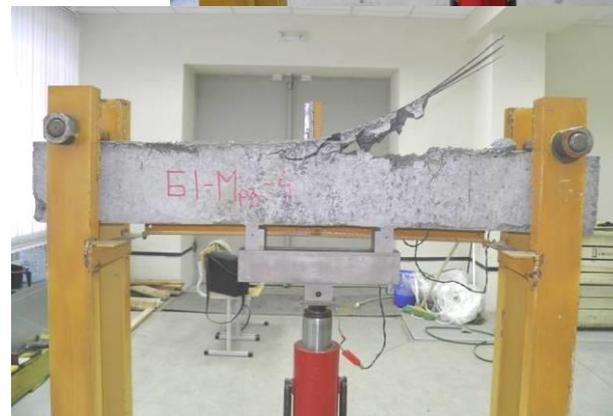
Проведенные исследования показали, что после 4,5,8 и 12 циклов попеременного замораживания и оттаивания железобетонных образцов, усиленных композиционными материалами FibARM изменение значения несущей способности происходит в пределах доверительного интервала измерений.
