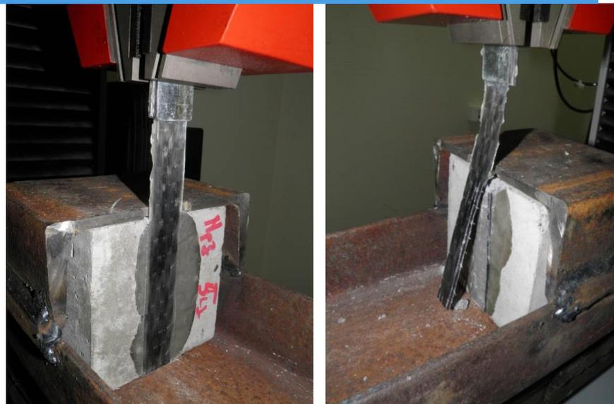
Вид образцов: до и после испытания на сдвиг холста
