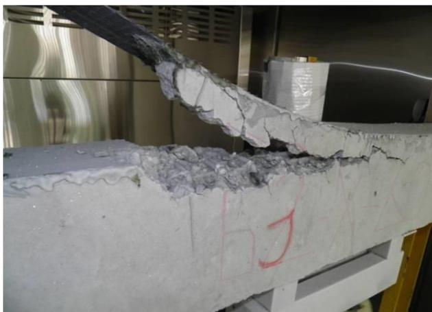
Вид усиленных образцов подгруппы «холод»: до испытания и после испытания при температуре -50 °С
