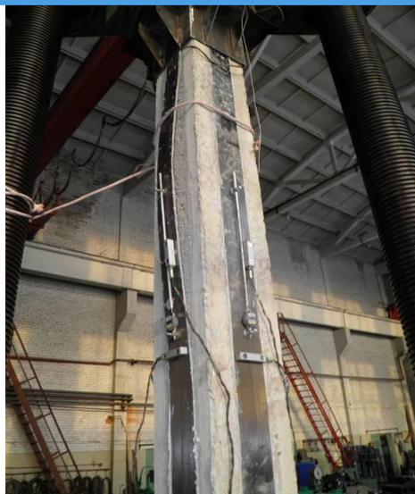
← Вид усиленных лентой образцов (без хомутов) подвергшихся испытаниям на прочность
