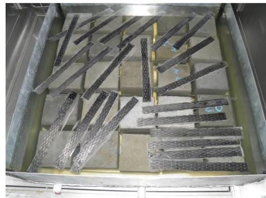
Испытания показали, что попеременное замораживание и оттаивание не оказывает негативного воздействия на адгезию эпоксидного клея FibARM Resin 230 к поверхности бетона.
