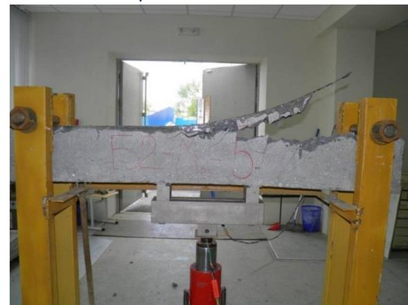
Вид усиленных образцов: до и после испытания
