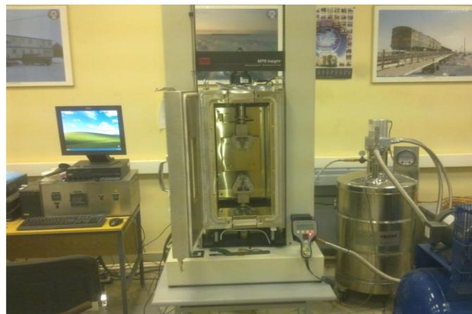
Внешний вид испытательной машины MTS Insight30 с температурной камерой
