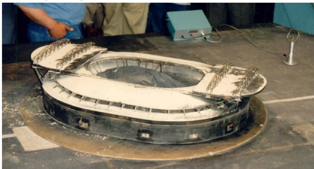
*Рис. 11. Продувка модели в аэродинамической трубе*
