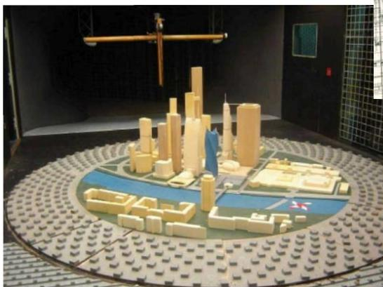
Испытания в АДТ. Wind tunnel
