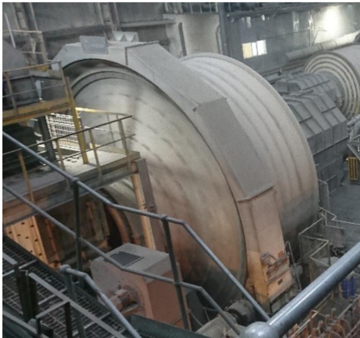
Рис.1 - Общий вид рассчитываемой размольной мельницы на фундаменте ФОМ3
