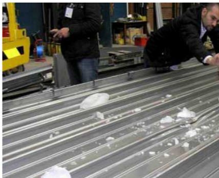
Рис. 43. Вмятина на ребре панели после падения груза
