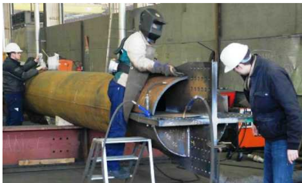
Рис. 47. Подготовка концевой вставки под сварку
