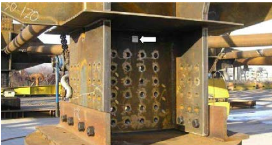
Рис. 50. Светоотражающий репер (показан стрелкой)
