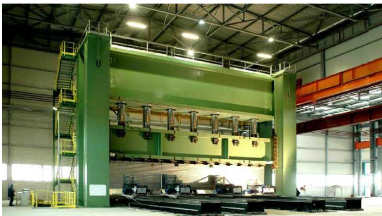
Рис. 44. Гибочный пресс с шириной зева 15,1 м и давлением на нож 6000 тс
