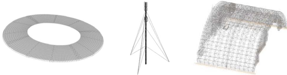
**Рис. 1.1-2.** Расчетные схемы оболочки, мачты и стержневой конструкции
