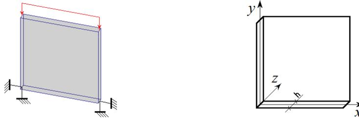
Рис.4.1-1. Плосконапряженное состояние
