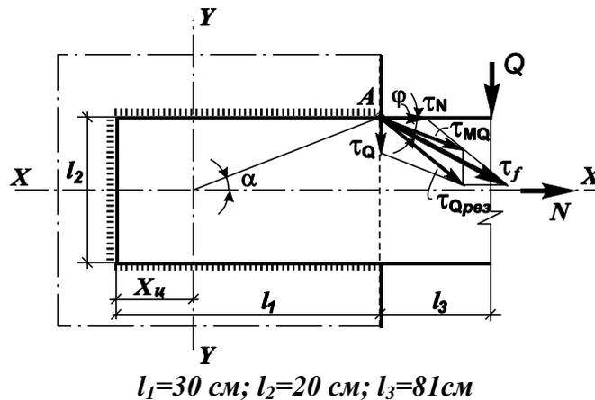
**Задача:** Выполнить проверку сварного соединения на угловых швах. Соединение нагружено продольной и поперечной силами.
