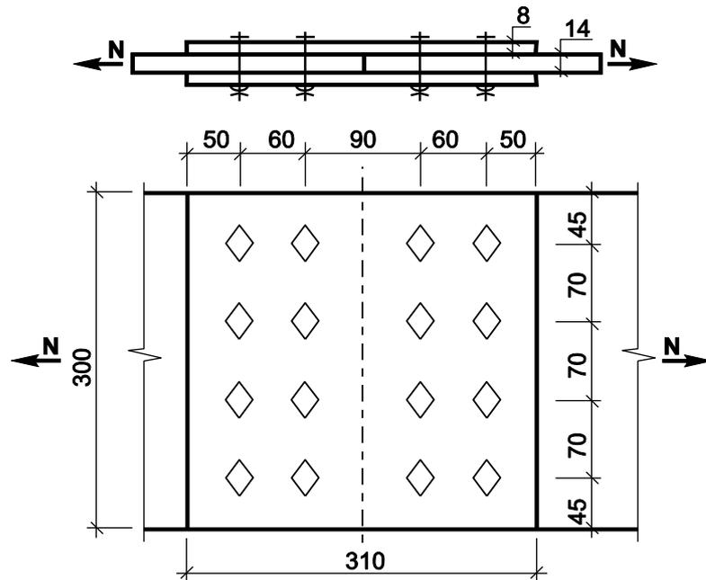
**Задача:** Выполнить проверку нахлесточного соединения листов размером 300x14 мм на болтах обычной прочности из стали марки С275 на действие срезающего усилия.
