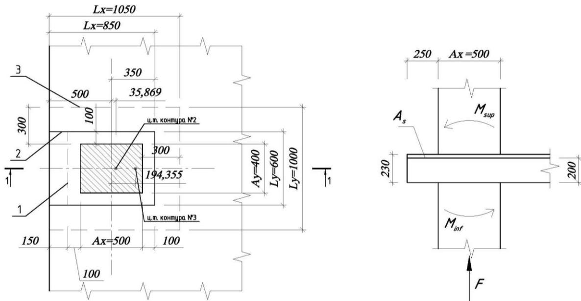
1 – замкнутый расчетный контур №1, 2 – незамкнутый расчетный контур №2, 3 – незамкнутый расчетный контур №3.
