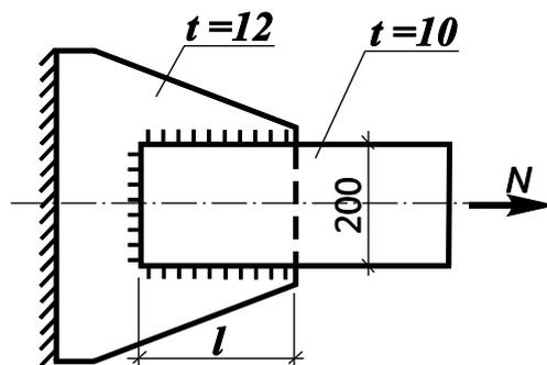
**Задача:** Выполнить проверку сварного соединения на угловых швах крепления растянутого элемента, выполненного внахлест.
