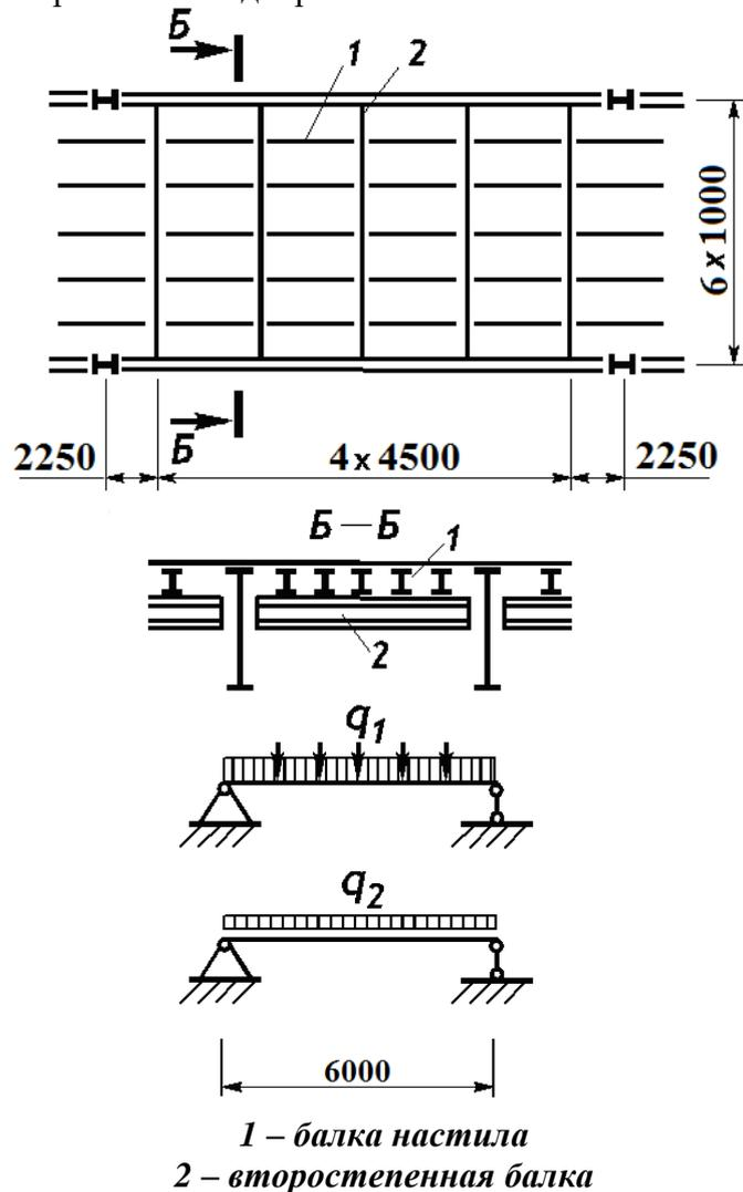
**Задача:** Подобрать прокатный двутавровый профиль для второстепенных балок пролетом 6 м в балочной клетке усложненного типа. Верхний пояс второстепенных балок раскреплен по длине балками настила, расположенными с шагом 1 м.
