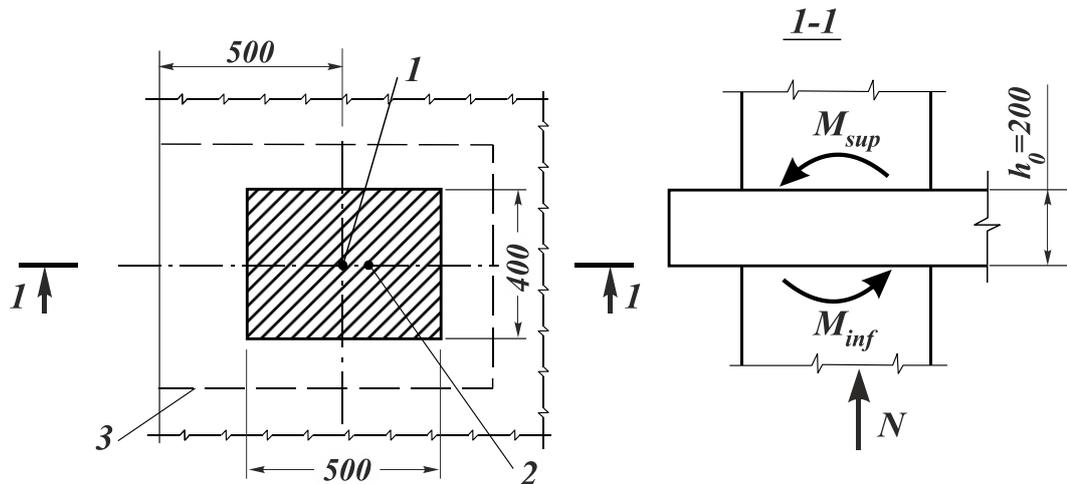
1 - точка приложения силы  $N$ ; 2 - центр тяжести незамкнутого контура; 3 - незамкнутый контур расчетного сечения
