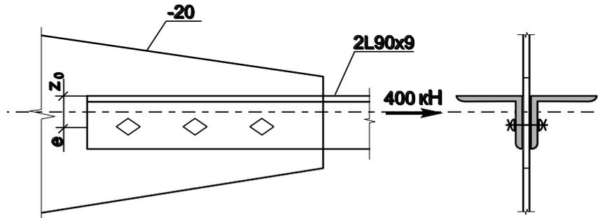
**Задача:** Выполнить проверку болтового соединения двух уголковых профилей 90x9 мм с фасонкой толщиной 20 мм на болтах класса прочности 8.8 на действие усилия среза в размере 400 кН.
