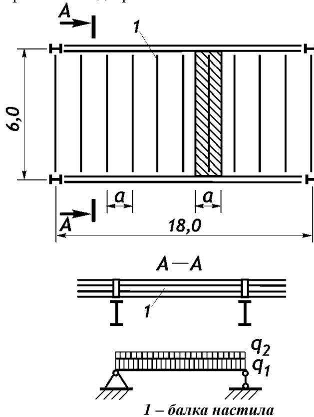
**Задача:** Подобрать прокатный двутавровый профиль для балок настила пролетом 6 м в балочной клетке нормального типа. Верхний пояс балок настила непрерывно раскреплен по всей длине настилом.
