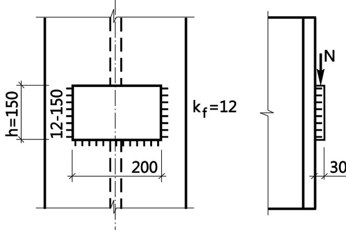
**Задача:** Выполнить проверку сварного соединения на угловых швах опорного столика с полкой колонны.
