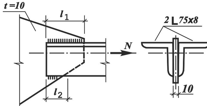
**Задача:** Выполнить проверку сварного соединения на угловых швах крепления растянутого стержня, состоящего из двух уголков 75x8, к фасонке.
