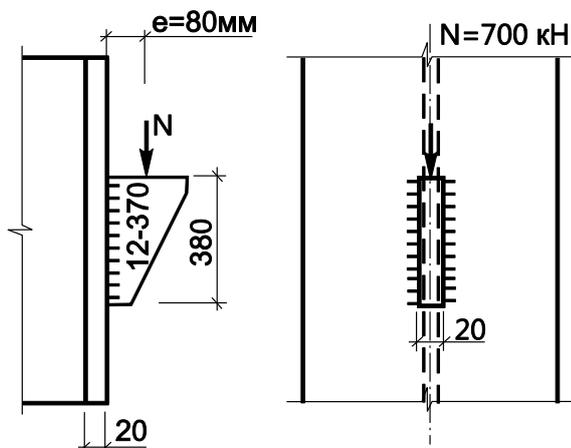
**Задача:** Выполнить проверку крепления опорного столика к полке колонны на действие силы, приложенной с эксцентриситетом. Крепление столика выполнено при помощи сварных угловых швов.
