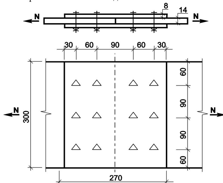
**Задача:** Выполнить проверку нахлесточного соединения листов размером 300x14 мм на высокопрочных болтах из стали марки С275 на действие срезающего усилия.
