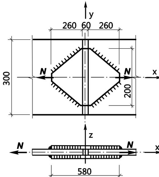
**Задача:** Выполнить проверку стыка двух растянутых полос, выполненного на накладках при помощи угловых швов.
