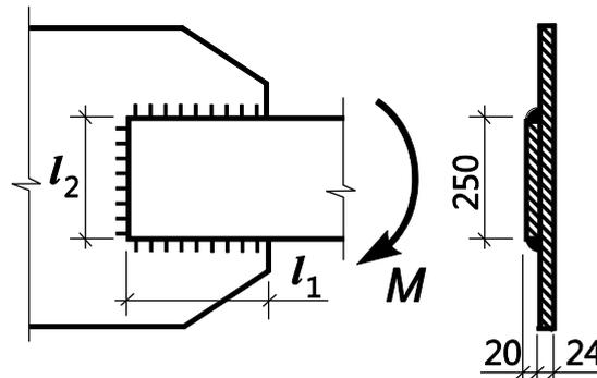
**Задача:** Выполнить проверку сварного соединения на угловых швах. Соединение нагружено изгибающим моментом, действующим в плоскости расположения швов.
