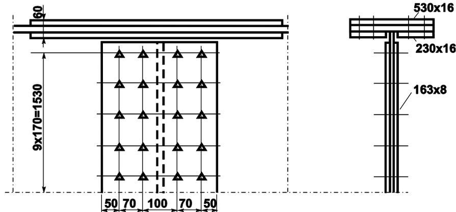
**Задача:** Проверить монтажный стык стенки составной двутавровой балки на высокопрочных болтах
