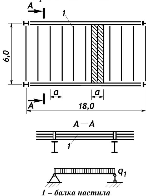
**Задача:** Проверить расчетное сечение прокатного двутаврового профиля для балок настила пролетом 6 м в балочной клетке нормального типа. Верхний пояс балок настила непрерывно раскреплен настилом.
