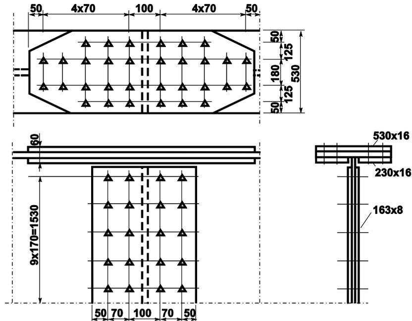
**Задача:** Проверить монтажный стык поясов составной двутавровой балки на высокопрочных болтах.
