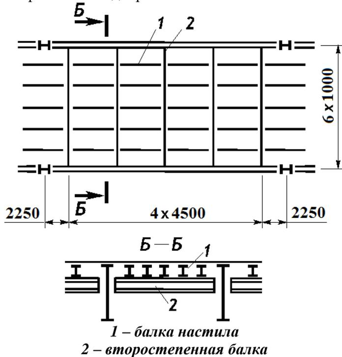
**Задача:** Подобрать прокатный двутавровый профиль для балок настила пролетом 4,5 м в балочной клетке усложненного типа. Верхний пояс балок настила непрерывно раскреплен по всей длине настилом.
