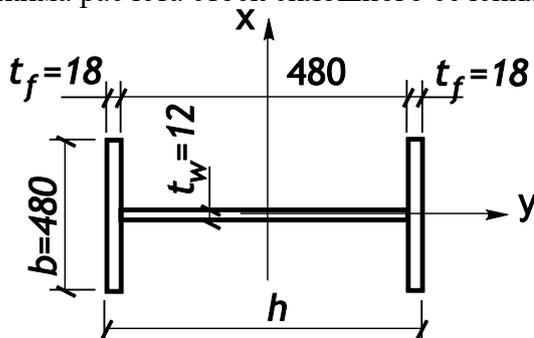
**Задача:** Проверить расчетное сечение сварного двутаврового профиля для центрально-сжатой стойки высотой 6,5 м.
