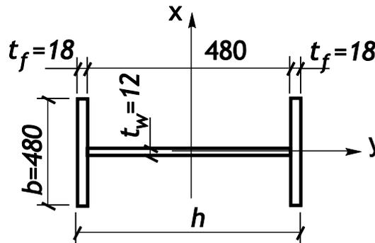
**Задача:** Проверить расчетное сечение сварного двутаврового профиля для центрально-сжатой колонны высотой 6,5 м.
