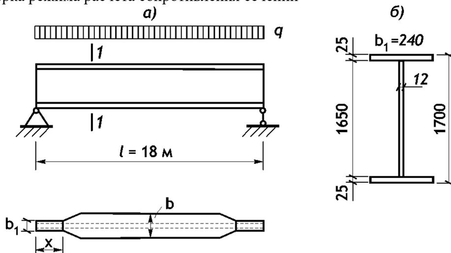
*а – схема изменения сечения по длине балки; б – сечение балки и эпюры напряжений*
