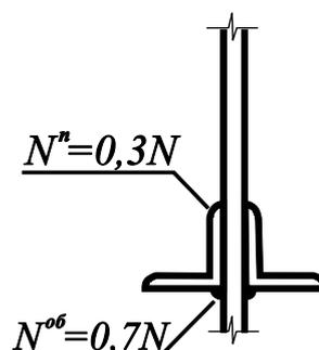
**Задача:** Проверить крепление к фасонке растянутого стального стержня, состоящего из двух равнополочных уголков.
